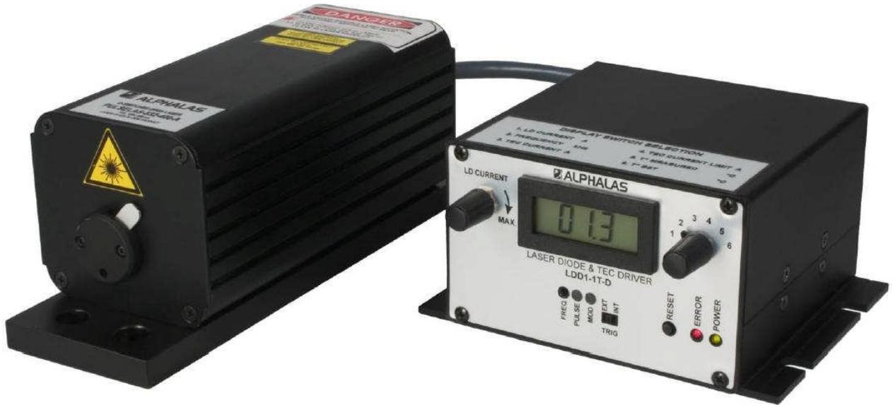
ダイオード励起ナノ秒 Q スイッチレーザーは、近赤外、可視、紫外において高出力・高品質(TEM<sub>00</sub>)のパルスを出力します。
